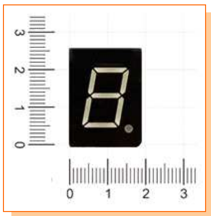
Detalle del dígito de 7 segmentos Dimensiones en [cm]
