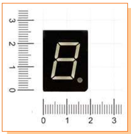
Detalle del dígito de 7 segmentos Dimensiones en [mm]
